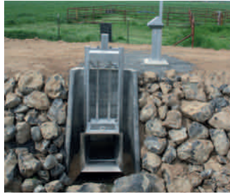
Y se reemplaza por un SlipMeter™ de instalación frontal
